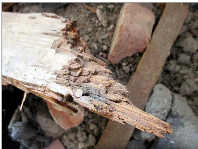
foto 7, 8: Detail hnilobou slabě poškozeného trámového zhlaví resp. hnilobou a hmyzem poškozeného prkna záklopu v sondě P-4
